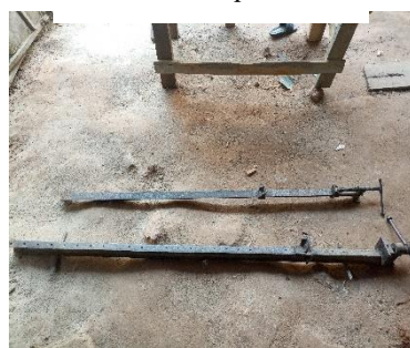
Photo 20 : Serre joints/ Dormant
