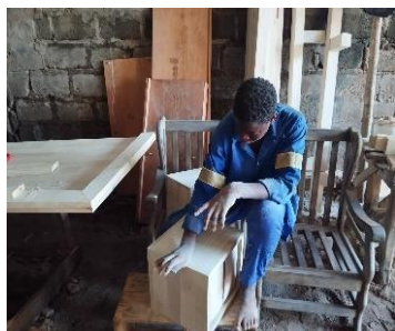
Photo a : Ponçage à main de caissons
